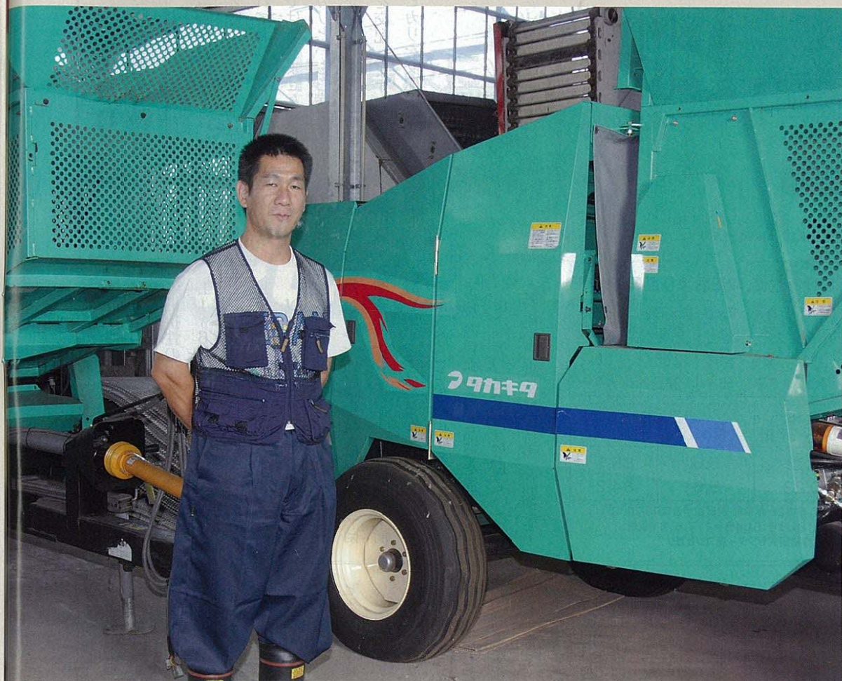
▲2台の細断形ロールペーラで適正な長さに裁断する
